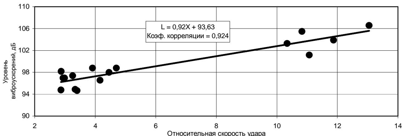
Рисунок 6. Зависимость общих уровней виброускорений на подшипниковой опоре испытательной коробки от скорости удара зубьев
