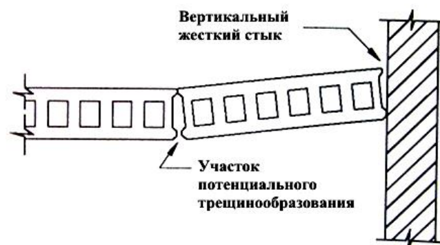
Рис. 8. Разрушение первого внутреннего продольного узла в месте примыкания к вертикальному элементу жесткости
