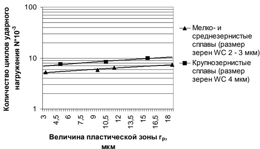
Рисунок 2. Зависимость износостойкости твердого сплава при ударно-усталостном изнашивании от величины пластической зоны (прямой удар, энергия удара 60 Дж, комбинированные зубки формы Г26 по ГОСТ 880-75)
