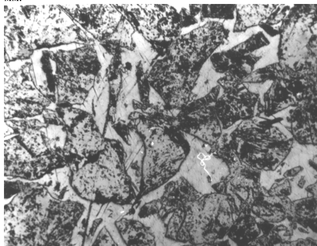
Рисунок 2. Микрофотография поверхности и структура композиционного материала (x 70) до испытания
