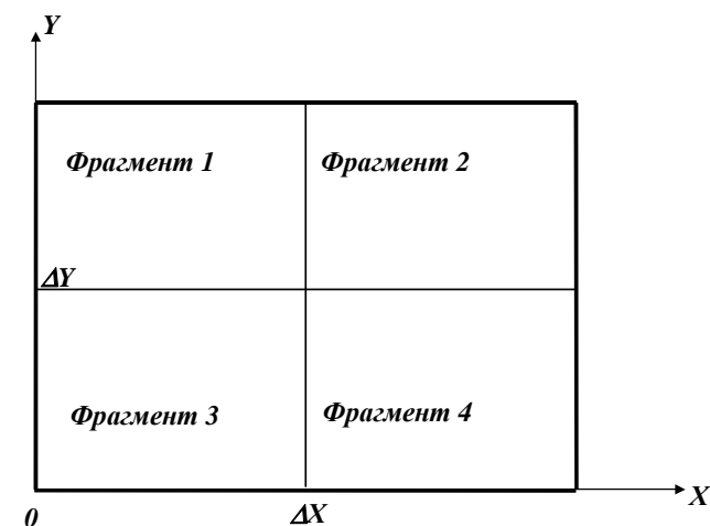
Рисунок 2. Схема, поясняющая процедуру преобразования координат при вводе графического документа с помощью УВГИ при разбиении чертежа на фрагменты
