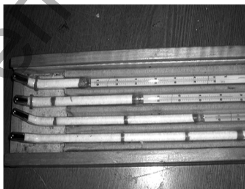
Рисунок 4.2 - Рисунок – Термометр Савинова (почвенный) ТМ–5 термометры метеорологические коленчатые (Савинова) (а – в футляре, б – в почве)
