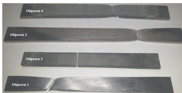
Рисунок 4 – Плоские образцы после испытаний на разрыв
