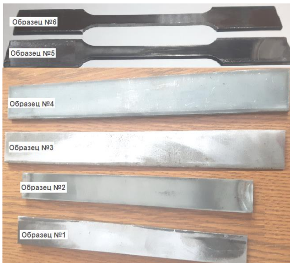
Рисунок 1 – Плоские образцы для механических испытаний
