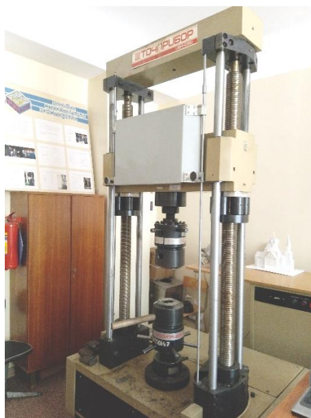
Рисунок 2 – Разрывная машина ИР 5145-500-11
