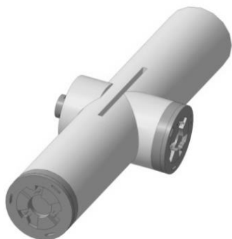
Рисунок 6 – Пример центрального модуля с замковыми соединениями
