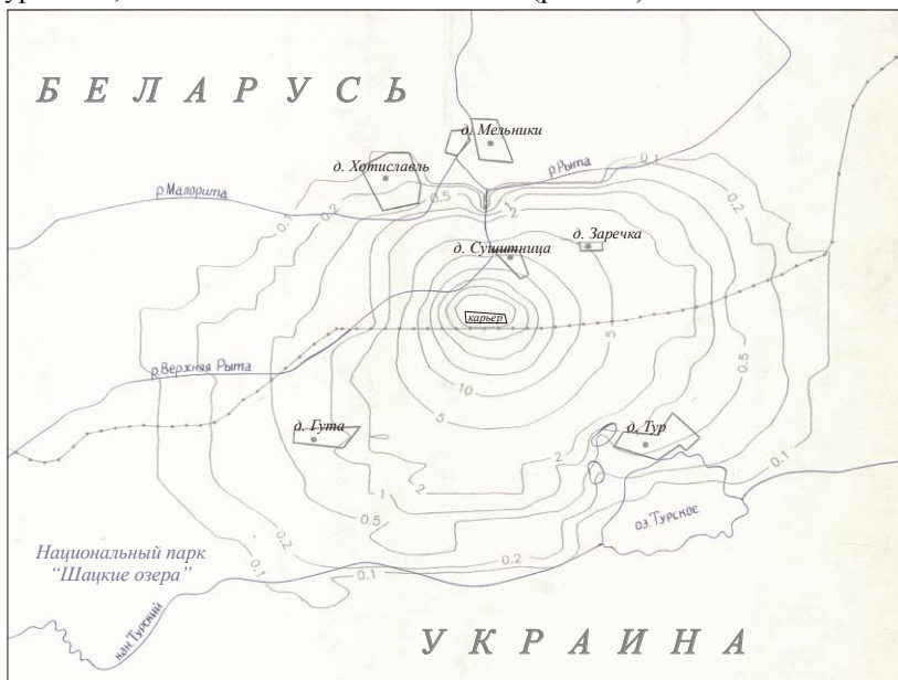
Рис. 5.3. Карта-схема прогнозного понижения уровня подземных вод при эксплуатации карьера «Хотиславский» за 45 лет эксплуатации.
