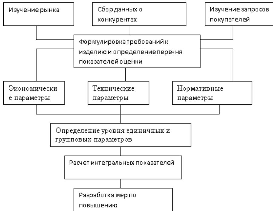
Рис.4.1. Блок-схема анализа конкурентоспособности продукции
