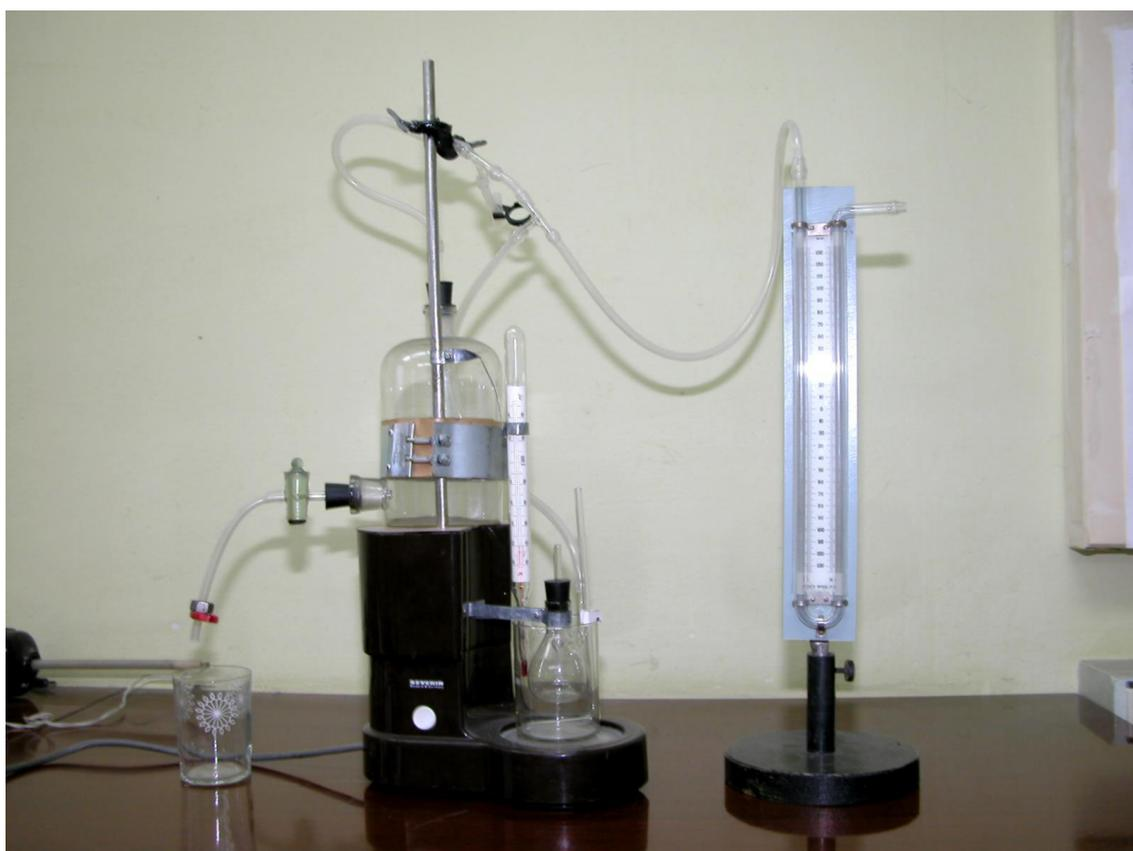
Рисунок 1. Установка Ребиндера
