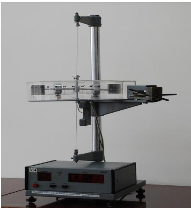
Ее компоненты: 1) – баллистический маятник из стержней с перемещающимися на них грузами; 2) - мишень; 3) - стреляющее устройство 4) - фото-датчик; 5) - счетчик колебаний; 6) - миллисекундомер; 7) - угловая шкала; 8) - клавиши управления.
