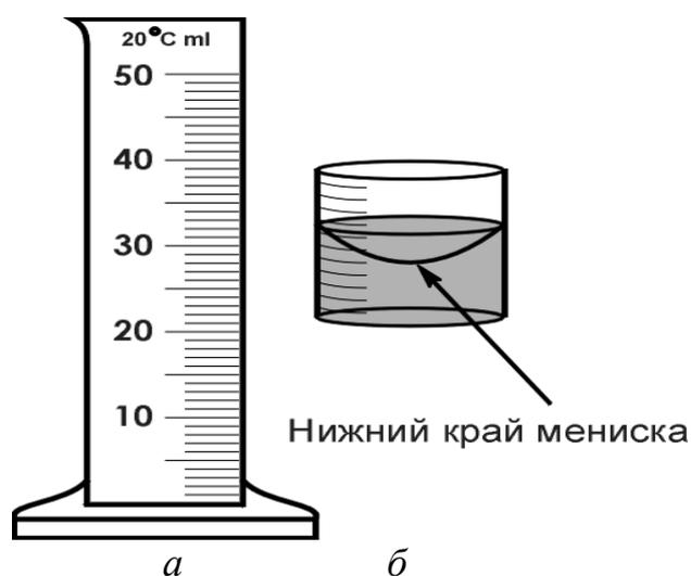
*а – общий вид; б – измерение уровня жидкости по нижнему краю мениска (для жидкостей, смачивающих стекло)*
