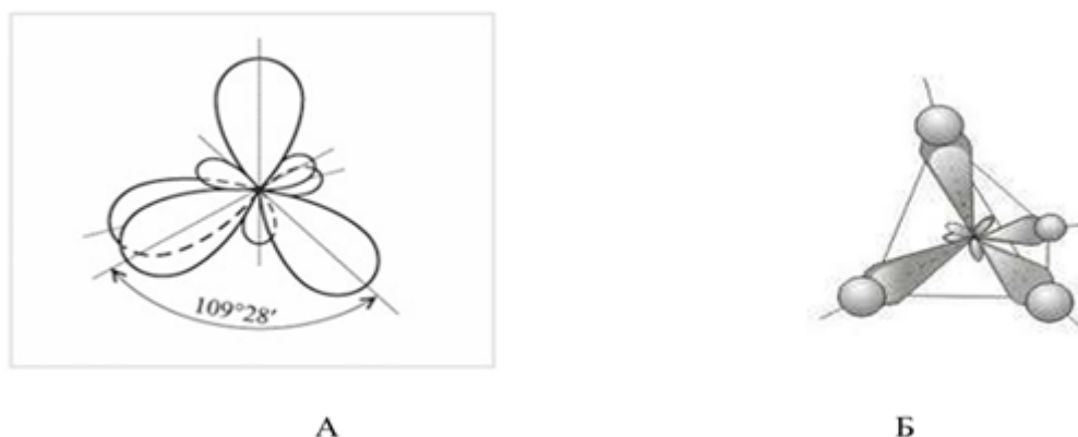
Рис.2. Схема взаимного расположения sp^3 -гибридных орбиталей (А) и модель молекулы метана (Б)
