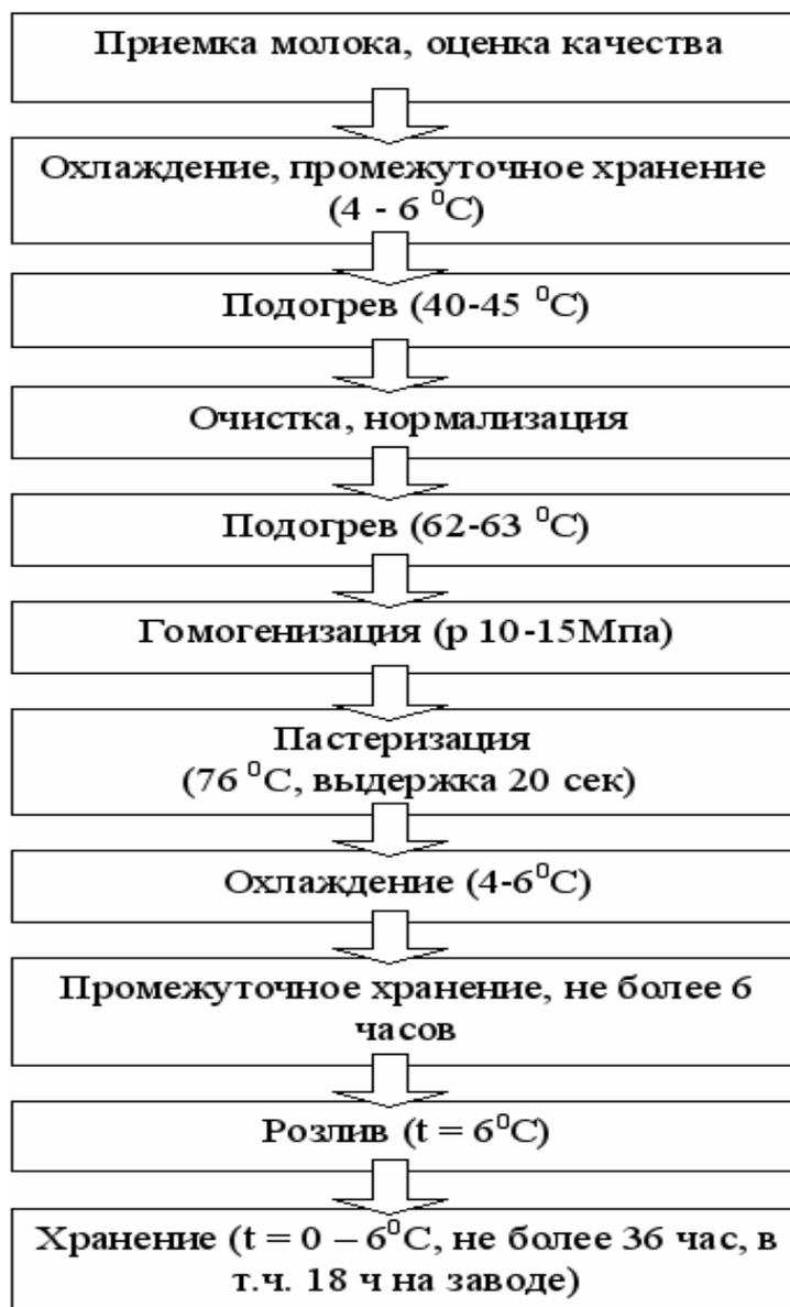
**Подогрев.** Молоко подогревают до температуры 40-45<sup>0</sup>С в секции регенерации автоматизированной пастеризационно-охладительной установке. Осуществляется для нормализации сырья и его очистки.
