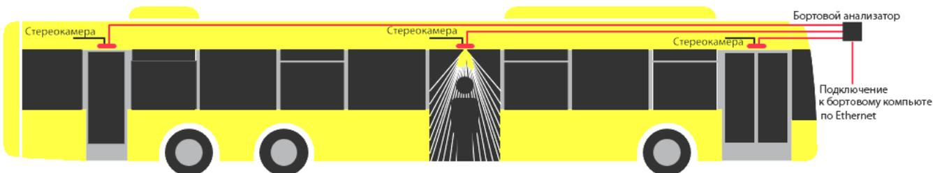
**Рисунок 2** – Схема АСПП в автобусе
