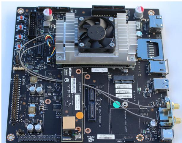
Рисунок 4 – Пример анализатора Nvidia Jetson TX1
