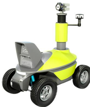
Рис. 2 Робот обнаружения и локализации утечек газа
