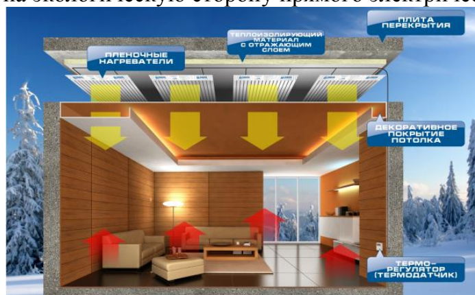
Рис. 5 Процесс инфракрасного излучения в доме
