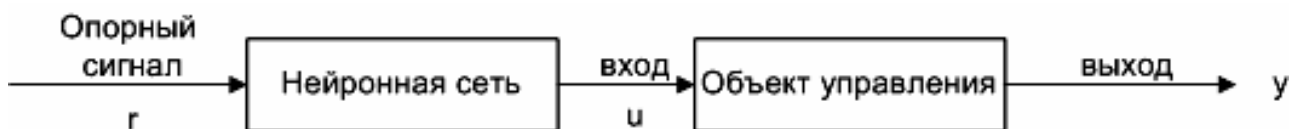
Рисунок 1 – Последовательная схема нейронного управления
