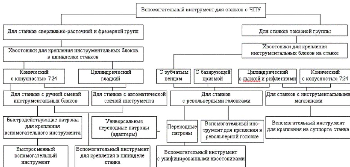
Рисунок 14.5 – Классификация вспомогательного инструмента для станков с ЧПУ
