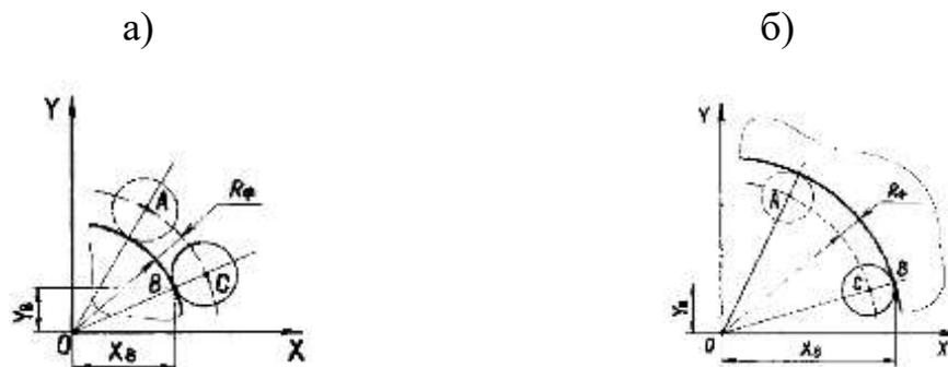
Рисунок 12.2 - Схема перемещения фрезы по дуге окружности, эквидистантной программируемому контуру.
