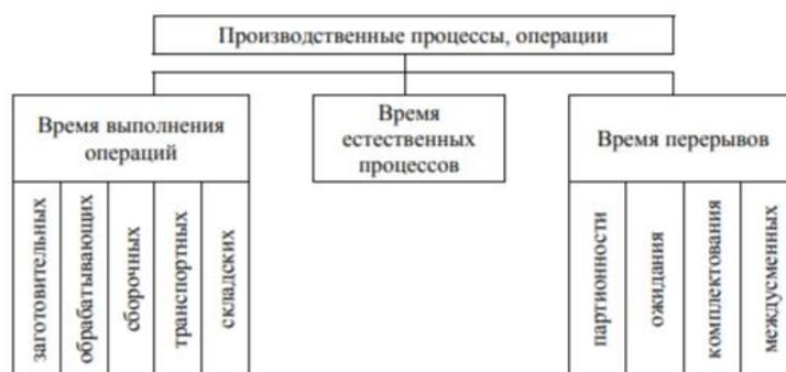
Рис. 6. Типичная структура производственного цикла
