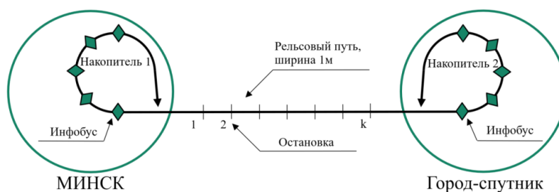
Рисунок 3 – Реверсная кассетно-конвейерная линия
