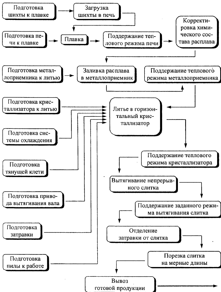
Рисунок 1.2 - Структура технологического процесса горизонтального непрерывного литья
