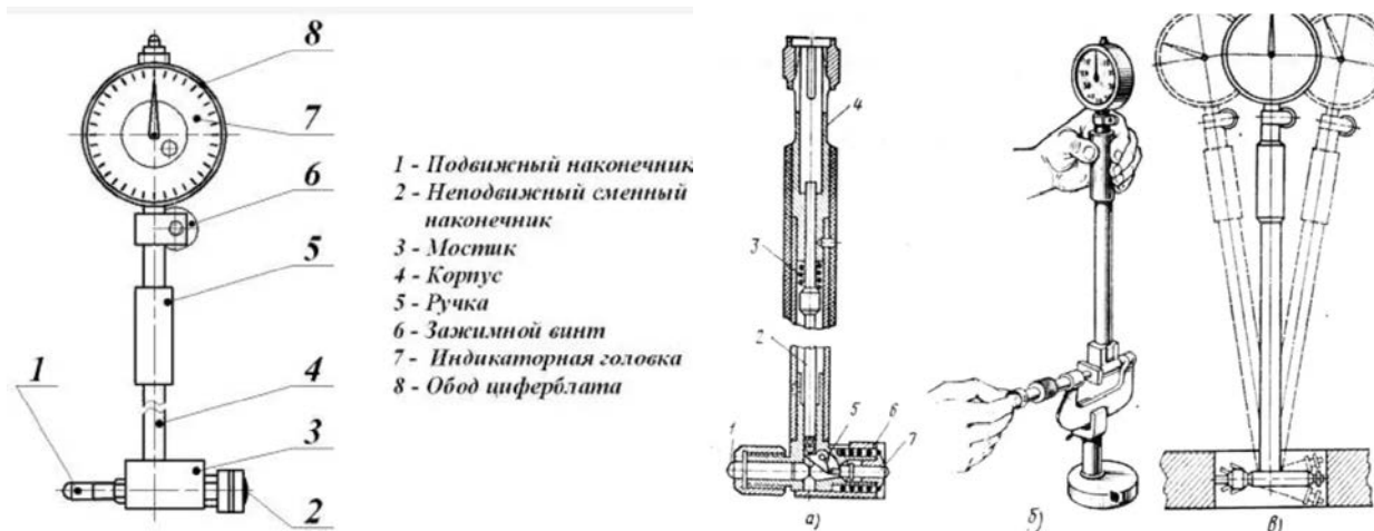
Рисунок 6.7 – Нутромер индикаторный
