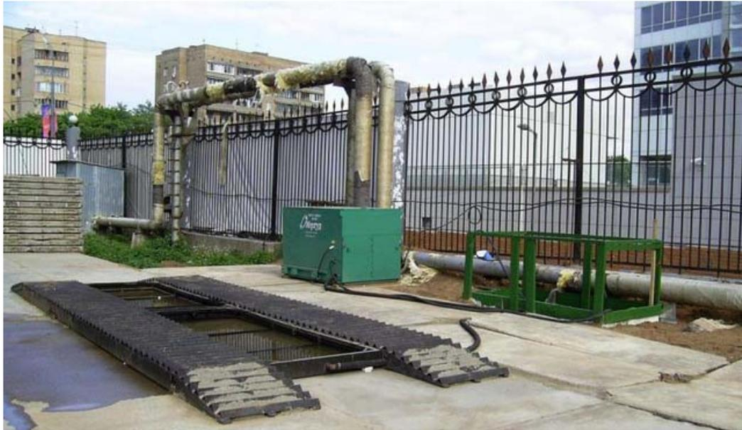
*Рисунок 5 Устройство для мойки колес*
