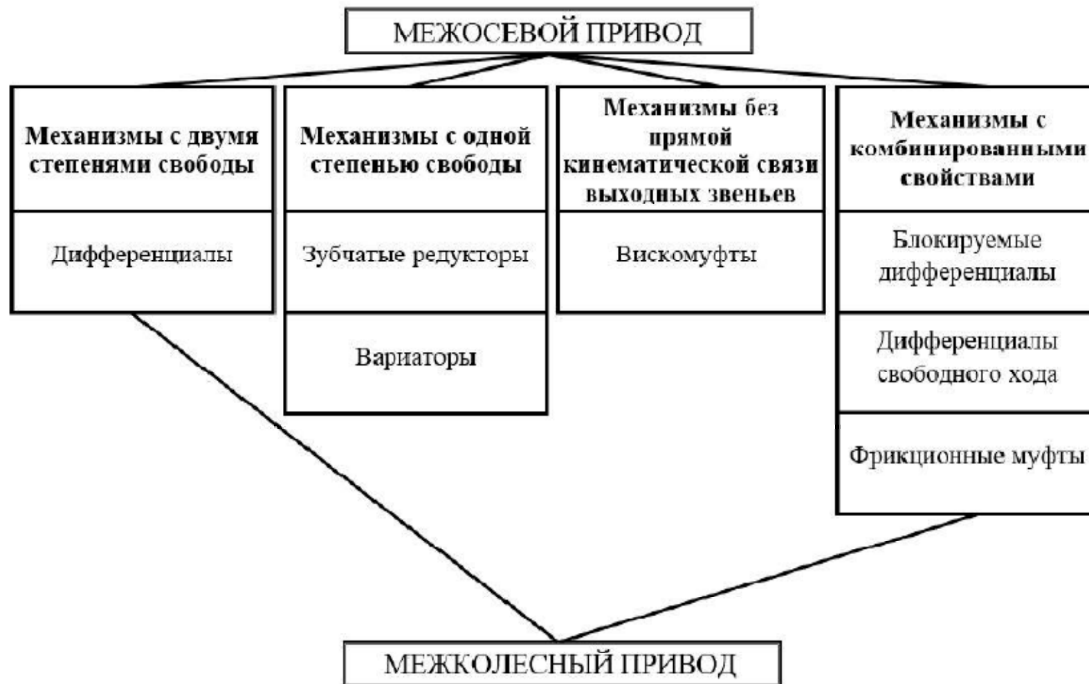
Рис. 7.5. Механизмы, применяемые в приводе ходовых систем полноприводных машин
