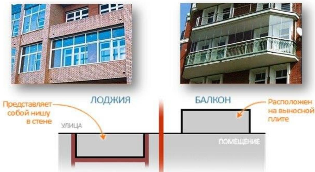
Рисунок 6.2 – Лоджии и балконы
