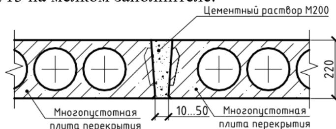
**Рисунок 7.9 – Заполнение продольных швов между плитами**
