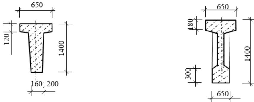
**Рис. 24. 16. Железобетонные подкрановые балки: а) – при шаге колонн 6м; б) – то же, 12 м**
