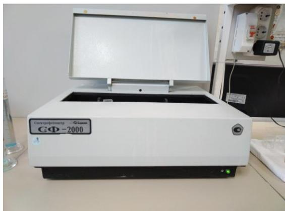
Рисунок 3 – Спектрофотометр СФ-2000
