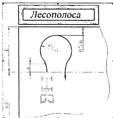
Рисунок 4 – К определению ширины поворотной полосы: E – ширина поворотной полосы; L_p – длина гона; R_0 – радиус поворота
