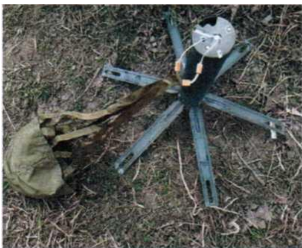
Рис. 1 Противопехотная мина ПОМ-3, устанавливаемая с помощью инженерной системы дистанционного минирования ИСДМ
