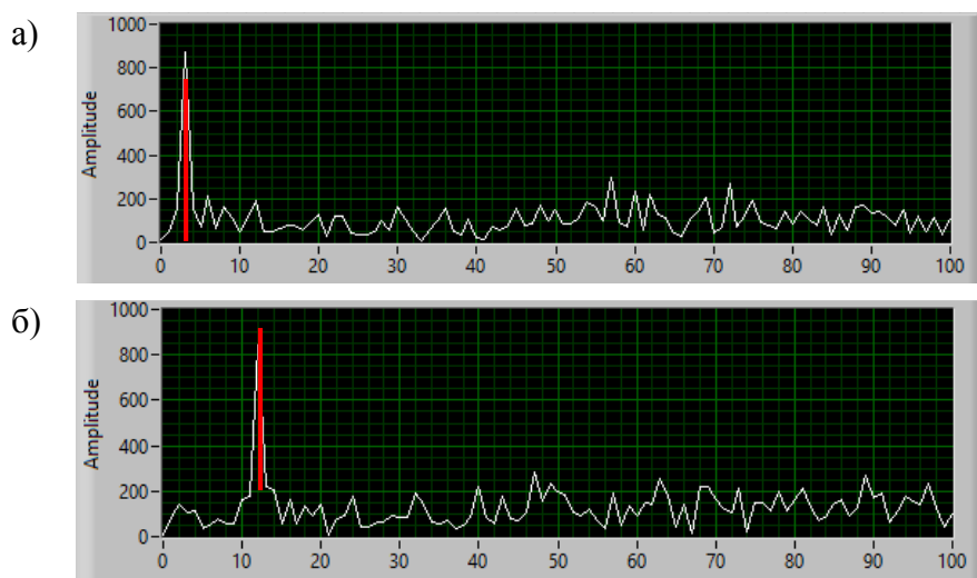
Рис. 5 Спектр информационного ЛЧМ, как результат преобразования Фурье (а – для кода «00», б – для кода «11»)
