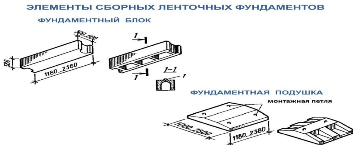
**Рисунок 3.3.1 – Сборные железобетонные ленточные фундаменты**
