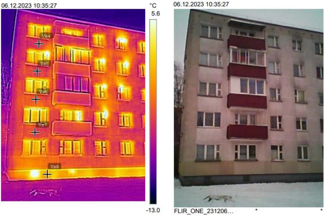
Рисунок 4 – Тепловизионное обследование участка главного фасада дома
