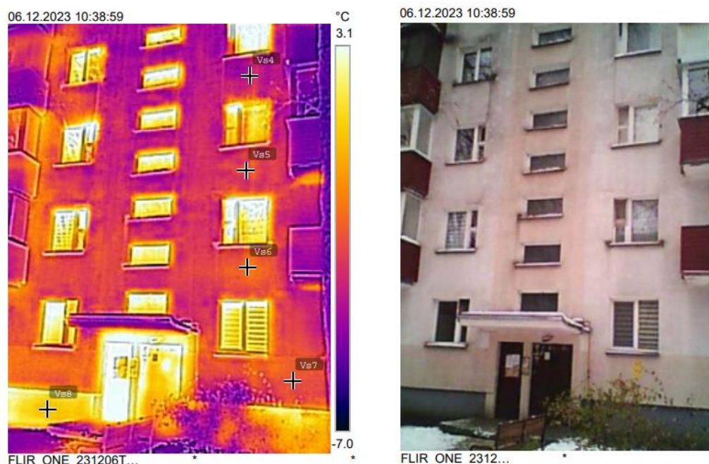
Рисунок 6 – Тепловизионное обследование участка дворового фасада дома
