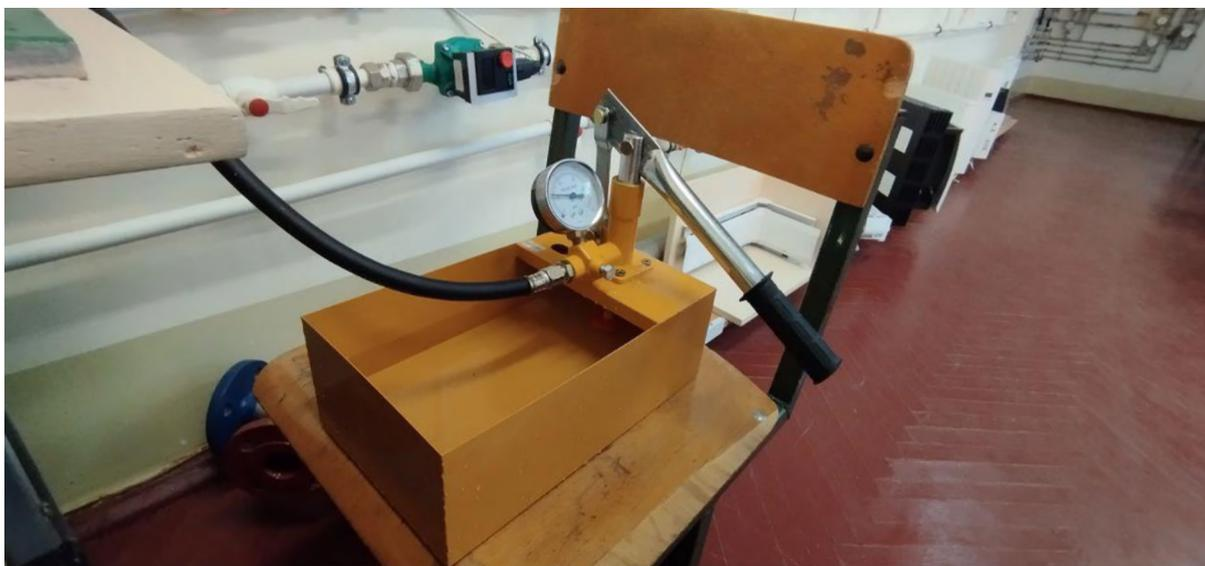
Рисунок 2 – Ручной опрессовочный насос
