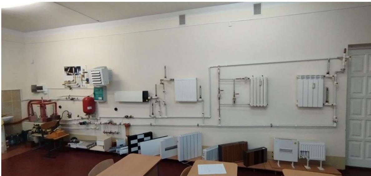
Рисунок 1 – Лабораторный стенд системы водяного отопления
