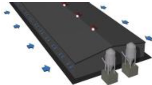
Рисунок 1 – Принцип действия вентиляции через воздуховоды
