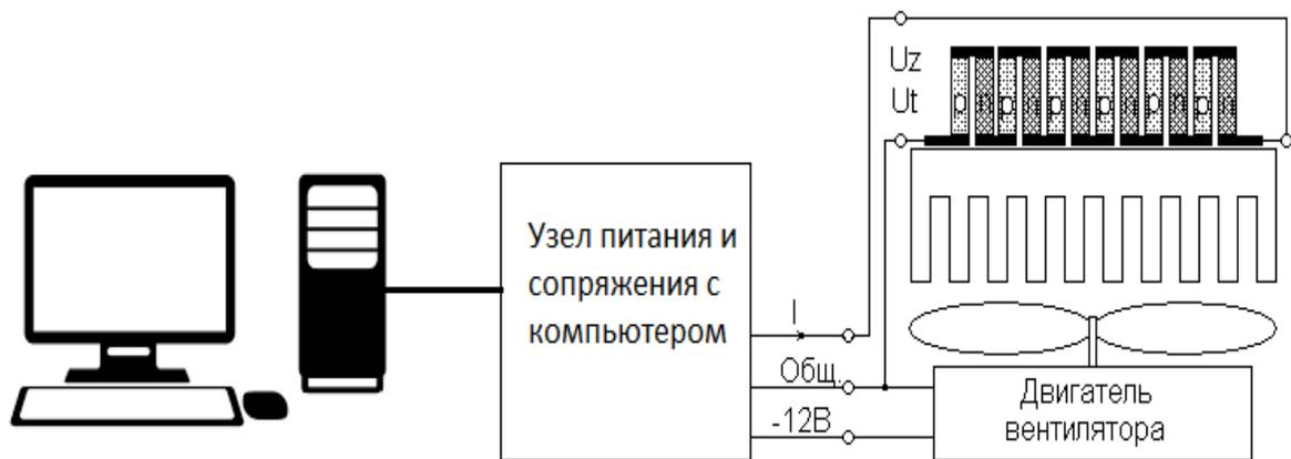
Структурная схема лабораторной установки для изучения термоэлектрических явлений
