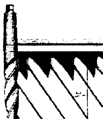
Рисунок 15 – Измерение угла наклона винтовой канавки \omega
