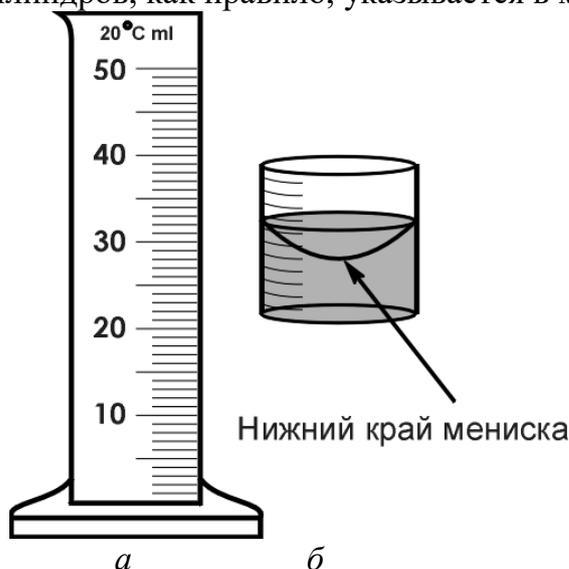
*а – общий вид; б – измерение уровня жидкости по нижнему краю мениска (для жидкостей, смачивающих стекло)*
