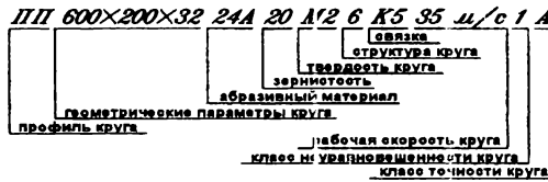
Рисунок 1 – Пример маркировки шлифовального круга
