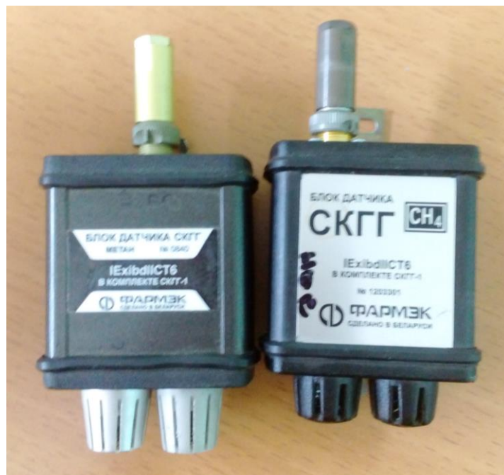
Рис.1.25. Блок датчика СКГГ-1.
