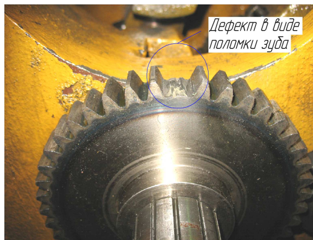
Рис. 2. Экспериментальное зубчатое колесо z=43 2-го вала привода с локальным дефектом в виде поломки зуба
