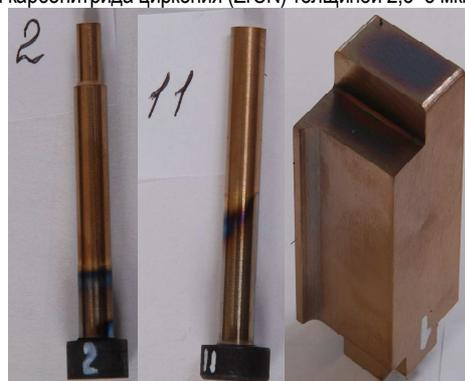
Рис. 4. Пуансоны с нанесенным покрытием
