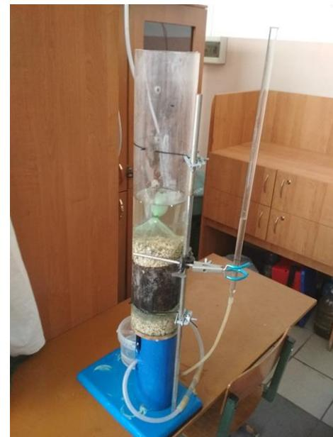
**Рисунок 3 – Общий вид установки для исследования сорбционной емкости брикетированного торфа в динамических условиях**
