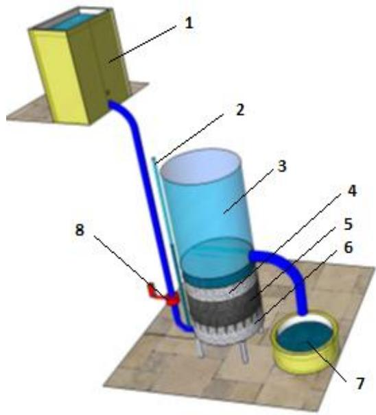
**Рисунок 2 – Схема установки для исследования сорбционной емкости брикетированного торфа в динамических условиях**
