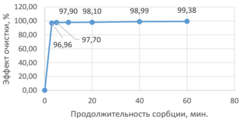
Рисунок 1 – Зависимость эффекта сорбции ионов Pb<sup>+2</sup> от продолжительности контакта
