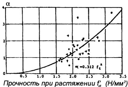
**Рис. 4.30.** Зависимость коэффициента  $\alpha$  от прочности бетона при растяжении по данным опытов [190]
