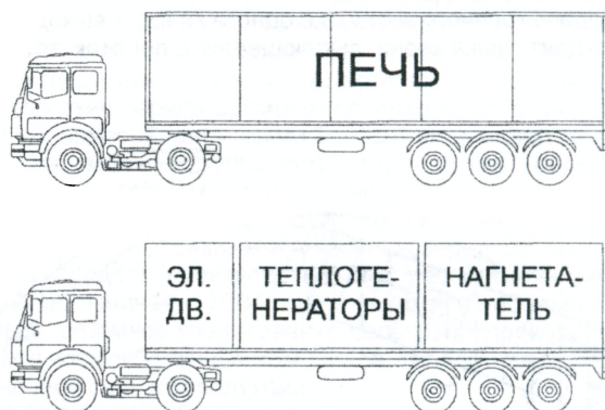
РИС. 4. МОБИЛЬНЫЙ КОМПЛЕКС СУШКИ ЗЕРНА В ТРАНСПОРТНОМ ПОЛОЖЕНИИ
