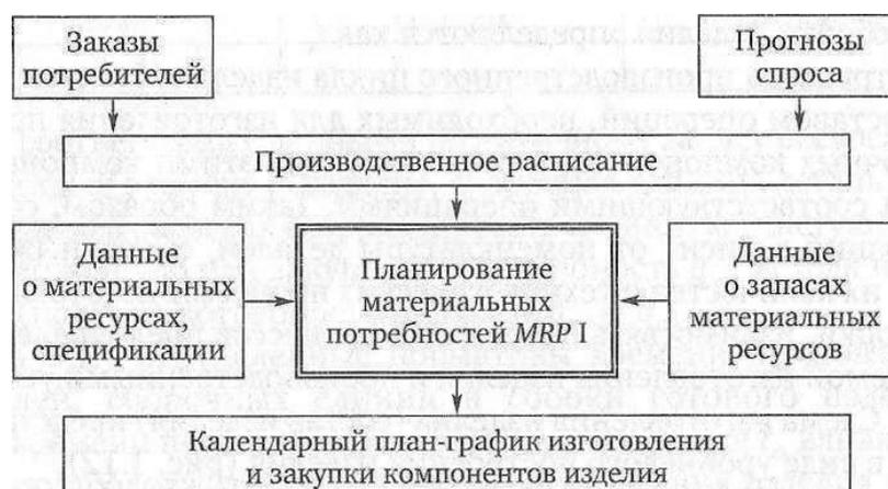
Рисунок 1.8 – Схема календарного планирования производства изделия
