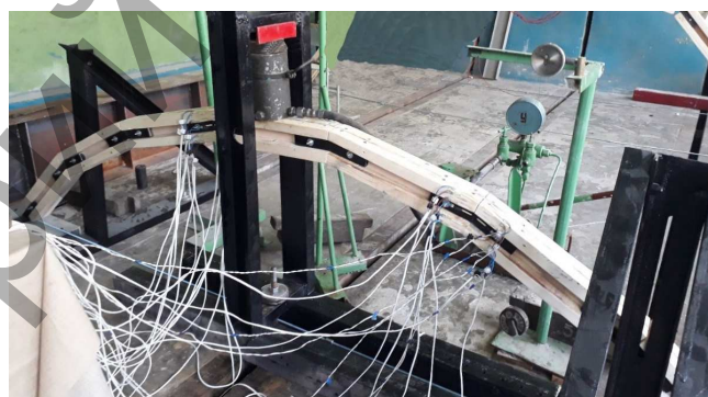
Рисунок 5 – Экспериментальная модель арочной полигональной конструкции пролетом 3 м, установленная на опоры
