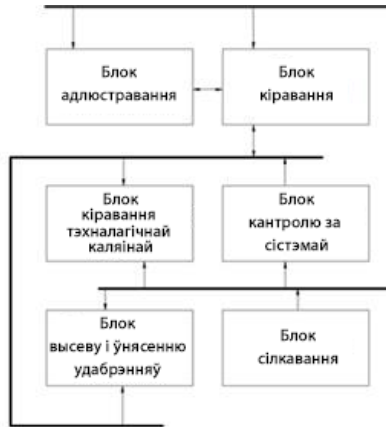
Малюнак 1 – Структура апаратнай часткі аўтаматызаванай сістэмы высева насення
