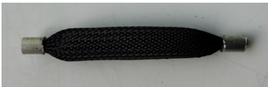
Рисунок 5 – Собранная и опрессованная мышца в оплетке
