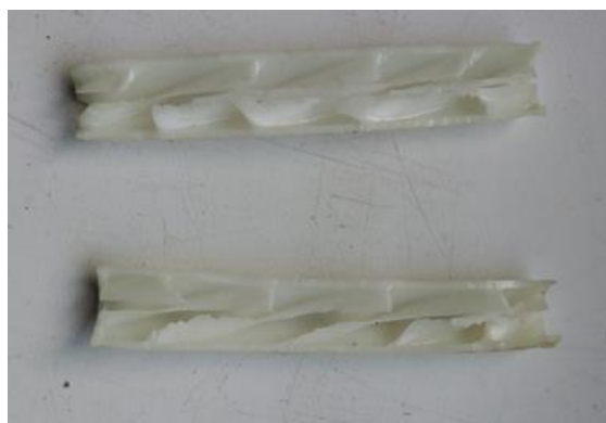
Рисунок 4 – Напечатанная мышца в разрезе
