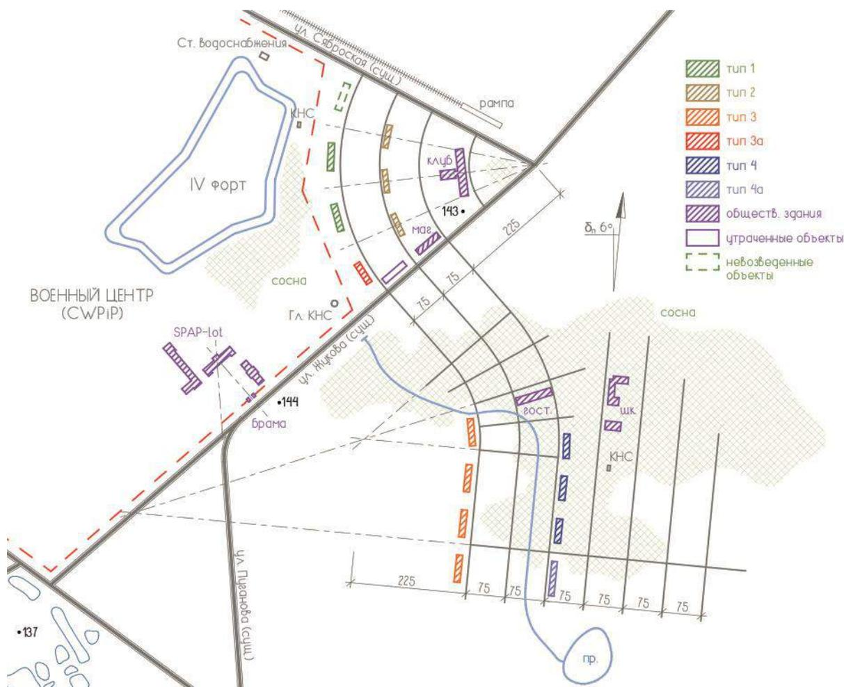
Рис. 2. Схема планировочной структуры жилого комплекса с указанием типов зданий.
