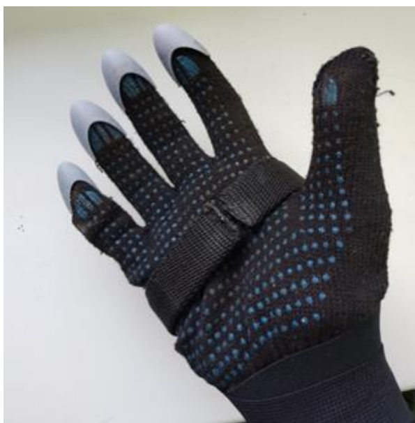
Рисунок 9 – Собранная перчатка с прикрепленными наконечниками для пальцев а также металлической пластиной вокруг ладони
