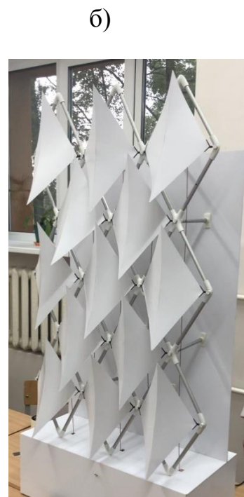
а) – чертёж прототипа каркаса с предполагаемой расстановкой движущихся сегментов; б) – рабочий прототип макета фасада
