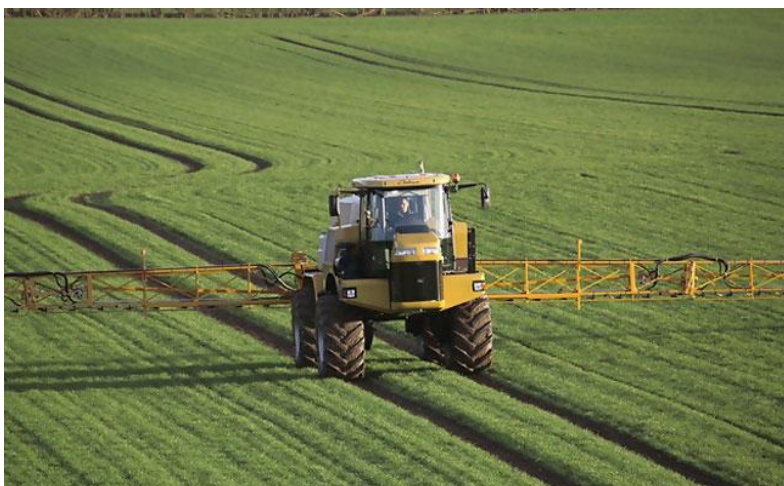
Рисунок 2 – Трактор, передвигающийся по технологической колее
