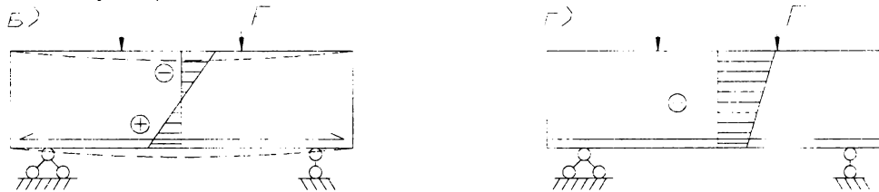
Рисунок 12.1 – Распределение напряжений в балке с обычной арматурой (а, б) и с преднапряженной арматурой (в, г).
